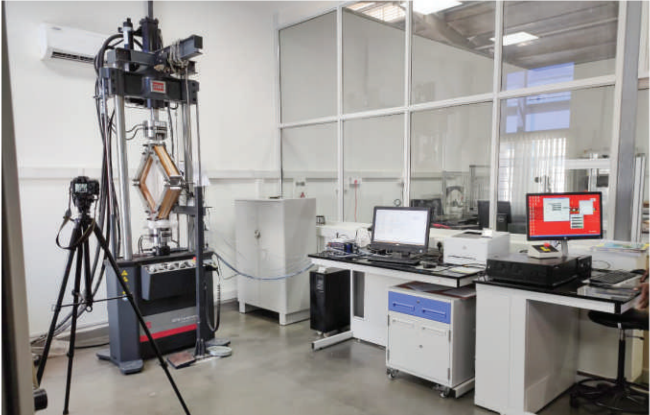
100केएन यूटीएम और डीएक्यू सिस्टम के साथ संरचनात्मक अभियांत्रिकी प्रयोगशाला का दृश्य
